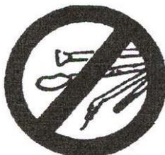
Важно отметить: Периодическая проверка состояния электродов очень важна. Если хирургическая вольфрамовая проволока порвётся, обуглится или если синяя изоляция будет порвана или повреждена, замените электрод в соответствии с пунктом 7.4.1
