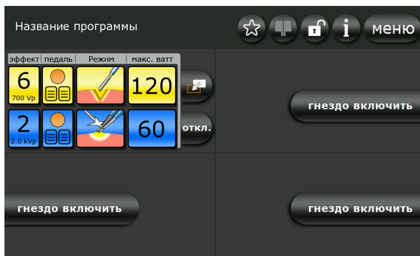
Рис. 5-33: Смена режима ZAP верхнего монополярного разъема
