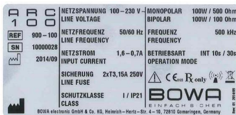
Рис 4-1: Паспортная табличка ARC 100
