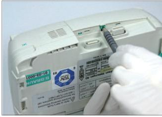
Протолкните дверцу с помощью ручки.
