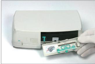
Извлеките рычаг из внутренней стороны крышки батарейного отсека.
