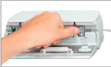
Установите инфузионную систему справа налево. Убедитесь, что она расправлена. Сначала проведите линию через входной датчик давления. Затем установите планку с двумя отверстиями.
