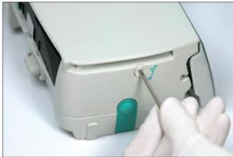
Поворачивайте рычаг, чтобы снять заглушку отверстия аварийного доступа.
