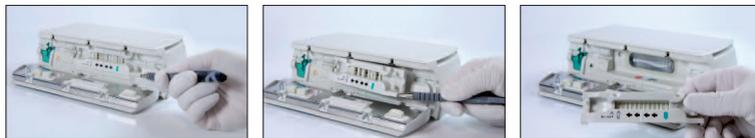
**Примечание.** Во время очистки удерживайте инструмент направленным вверх и не допускайте пропитывания частей инструмента жидкостью или погружения в нее.
