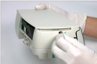
Чтобы открыть дверцу, поворачивайте рычаг внутри отверстия.
