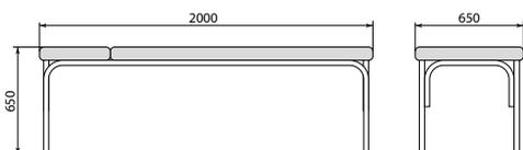
**Каркас** из гнутой круглой трубы диаметром 30 мм, покрытой порошковой краской цвета «хром», сборка на болтах.
