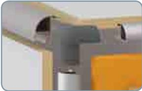
**Замок** из ударопрочного пластика ABS неотъемлемая часть каркаса, так как является узловым элементом соединения алюминиевых профилей. Допустимая нагрузка соединения до 150 кг. Данное сочетание придает жесткость конструкции сопоставимую со сварным металлическим каркасом.
