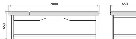
Ложе изготовлено из кожзаменителя марки SKADEN, Польша. Наполнитель поролон толщиной 40 мм. Крой бесшовный.
