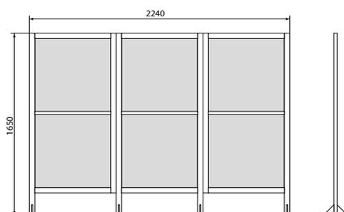
**Каркас мебели** изготовлен из бука без применения металлических соединений
