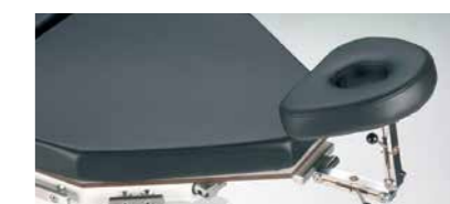
Специальный подголовник 18151 для офтальмологических операций. При использовании механизма с двойным соединением диапазон регулировок шире: от +90° до -60°.
