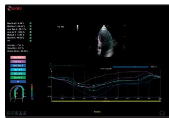
Технология XStrain™: Анализ глобальной деформации ЛЖ (GLS) с построением диаграммы типа «бычий глаз» (17 сегментов) по трем апикальным позициям.
